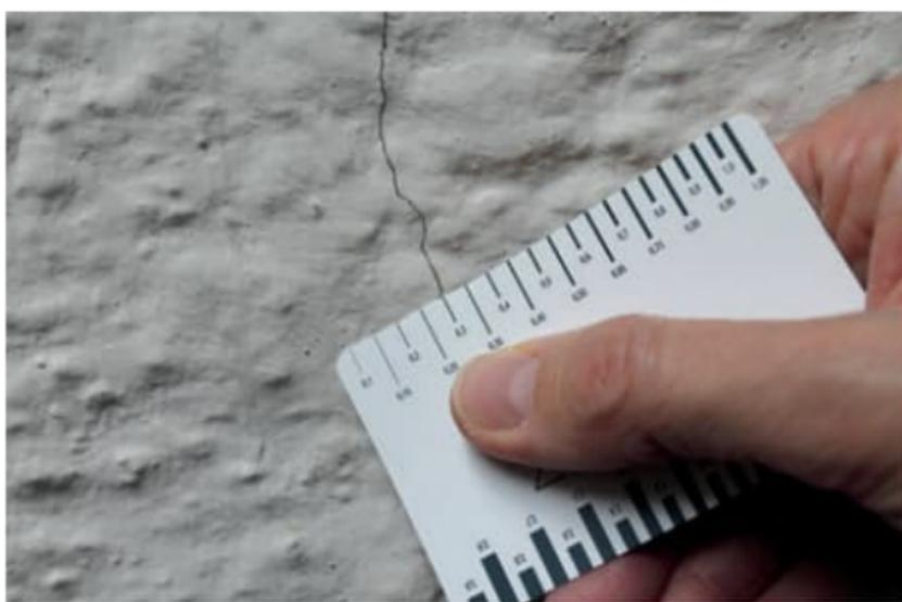
Für den Sachverständigen ist die sogenannte „Risskarte“ bei der Durchführung der Beweissicherung neben dem Aufnehmen von Fotos eines seiner wichtigsten Werkzeuge. Mit ihr kann er die Stärke von z. B. Rissen im Mauerwerk genau ausmessen und in die Dokumentation aufnehmen. Dauerhafte Messeinrichtungen wie Rissmonitore oder Gipsmarker werden bei Bedarf ebenfalls montiert und „nullgemessen“. Das bedeutet, dass sie ab dem Moment der Installation jede (Ver)Änderung registrieren.
