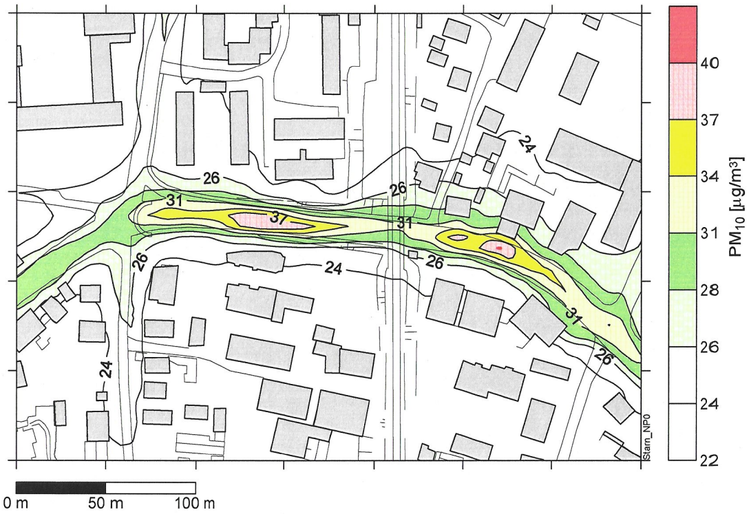
Abbildung 10.9: Nordportal – Jahresmittelwert 2012 der PM10-Belastung, 20% Portalabluft
