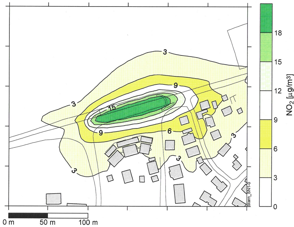
Abbildung 10.6: Südportal – Minderung 2012 der NO 2 -Belastung durch Mittenabsaugung
