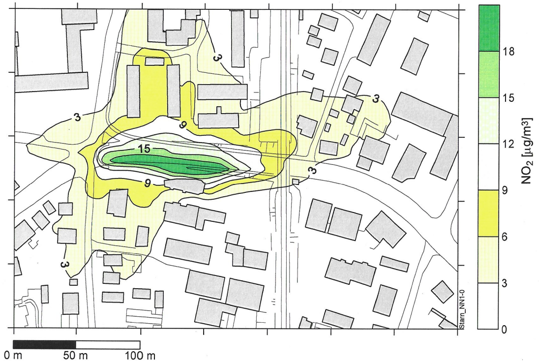
Abbildung 10.5: Nordportal – Minderung 2012 der NO 2 -Belastung durch Mittenabsaugung
