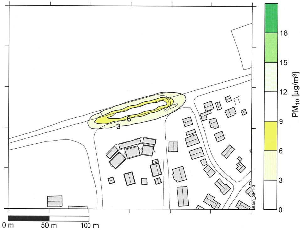
Abbildung 10.12: Südportal – Minderung 2012 der PM 10 -Belastung durch Mittenabsaugung
