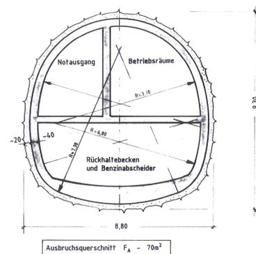
Schachtquerschnitt M 1:100
