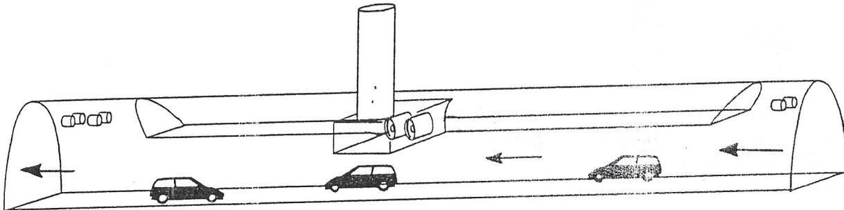
Längslüftung mit Absaugung in Tunnelmitte:
