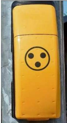
Das Grünsignal erscheint hier automatisch durch die Ampelsteuerung und kann nicht angefordert werden. Anforderung des Freigabesignals für Sehbehinderte an der Unterseite möglich.
