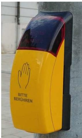
Hier kann das Grünsignal per Sensor an der Vorderseite angefordert werden. Anforderung des Freigabesignals für Sehbehinderte an der Unterseite durch Berühren der Oberfläche. Alternative Anforderung über den Taster an der Unterseite.
